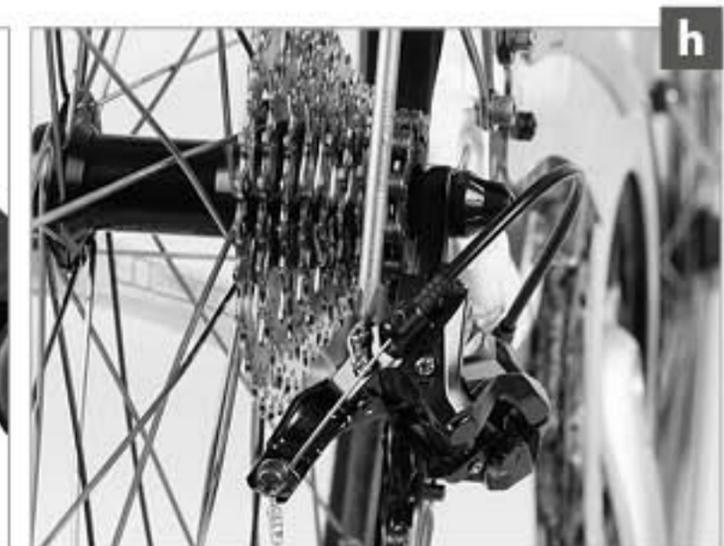
Durch diese Einstellung verhindern Sie, dass die Kette zwischen Ritzel und Speichen gerät oder das Schaltwerk bzw. sein Leitrollenkäfig die Speichen berühren kann – dadurch könnten Speichen, Schaltwerk und Rahmen beschädigt werden. Schlimmstenfalls ist eine Weiterfahrt nicht mehr möglich.
