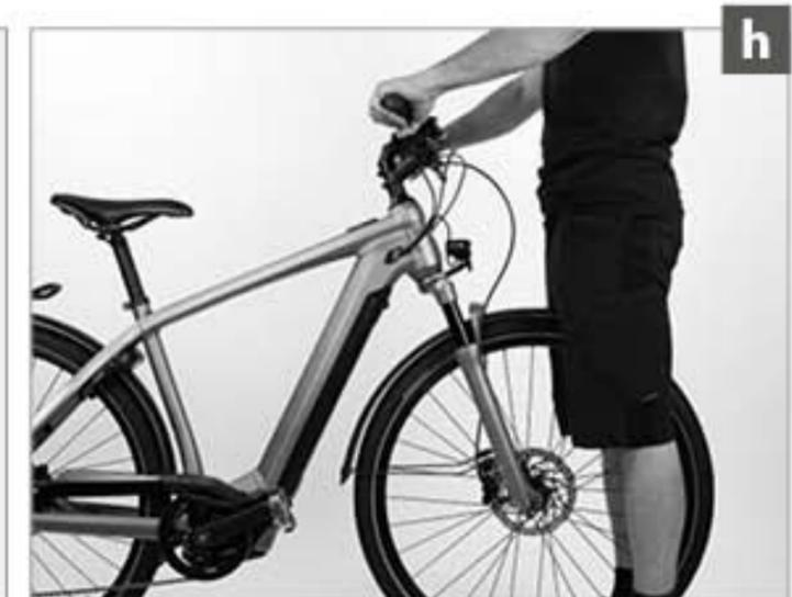
Um die Leichtgängigkeit des Lagers zu prüfen, heben Sie mit einer Hand den Rahmen hoch, bis das Vorderrad keinen Bodenkontakt mehr hat. Das Vorderrad muss ohne Einrasten von ganz links nach ganz rechts und zurück schwenken. Wenn Sie den Lenker leicht antippen, muss sich die Gabel selbsttätig aus der Mittelstellung herausdrehen (g).
