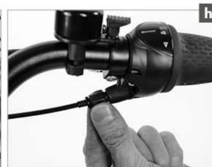
Kontrollieren Sie erneut, ob die Markierungslinien noch aufeinander ausgerichtet sind. Gegebenenfalls müssen Sie die Einstellung nochmals leicht korrigieren. Drehen Sie dazu erneut die Zugeinstellschraube am Schaltgriff schrittweise so weit im oder gegen den Uhrzeigersinn, bis die Markierungslinien deckungsgleich ausgerichtet sind.
