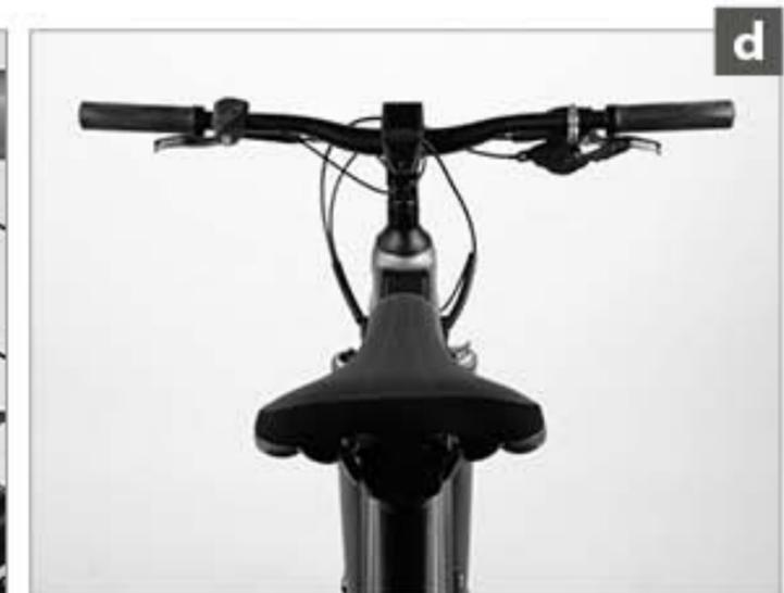
7. **Lassen Sie Ihr CROSS Pedelec aus geringer Höhe auf den Boden springen.** Gehen Sie auftretenden Klappergeräuschen nach. Prüfen Sie ggf. Lager, Schraubverbindungen und den korrekten Sitz des Akkus und der Stecker (e+f). Drehen Sie ggf. lose Schraubverbindungen etwas an.
