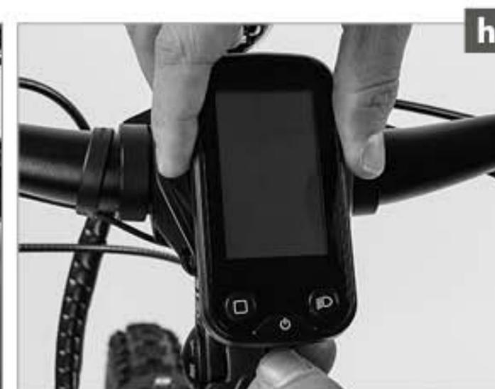
2. **Sitzt der Akku fest in seiner Halterung (a)** und sind die Verriegelung bzw. das Schloss korrekt geschlossen (b)? Fahren Sie nie los, wenn der Akku nicht fest in seiner Halterung sitzt und verriegelt ist.
