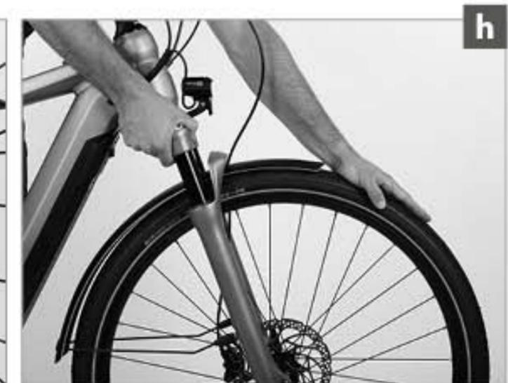
4. **Überprüfen Sie, ob Lenker und Vorbau nicht verbogen oder angebrochen sind**, und ob diese noch gerade stehen. Prüfen Sie, ob der Vorbau fest auf der Gabel sitzt, indem Sie versuchen, den Lenker gegenüber dem Vorderrad zu verdrehen (a). Stützen Sie sich auch kurz auf die Bremsgriffe, um den sicheren Halt des Lenkers im Vorbau zu überprüfen.
